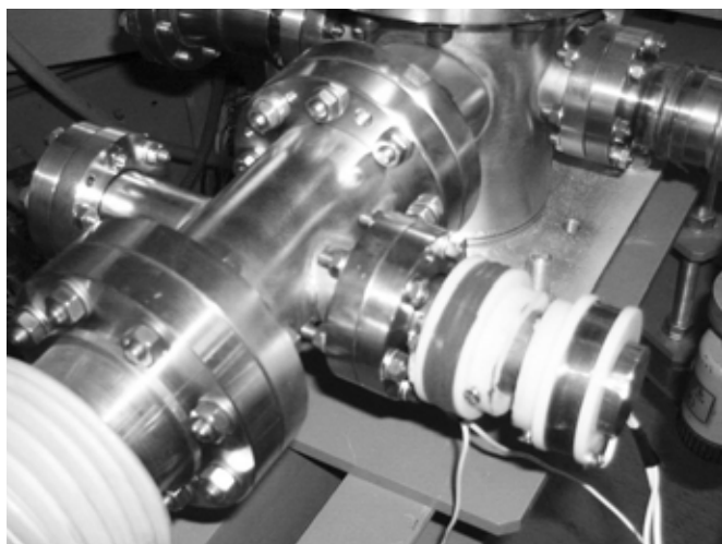
Экспериментальная установка. Белые кольца в правой нижней части — изоляция катушек L1, L2, которые управляют кареткой с пластинкой, перекрывающей путь излучения
